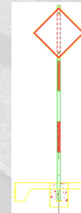
DETALLE CIMENTACION PARA SEÑALES PREVENTIVAS Y REGLAMENTARIAS ZONA RURAL
